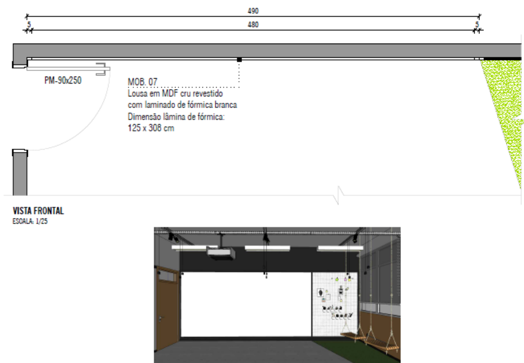
Figura 9 – Lousa em MDF cru, revestida com laminado de fórmica branca, conforme indicações de projeto.
