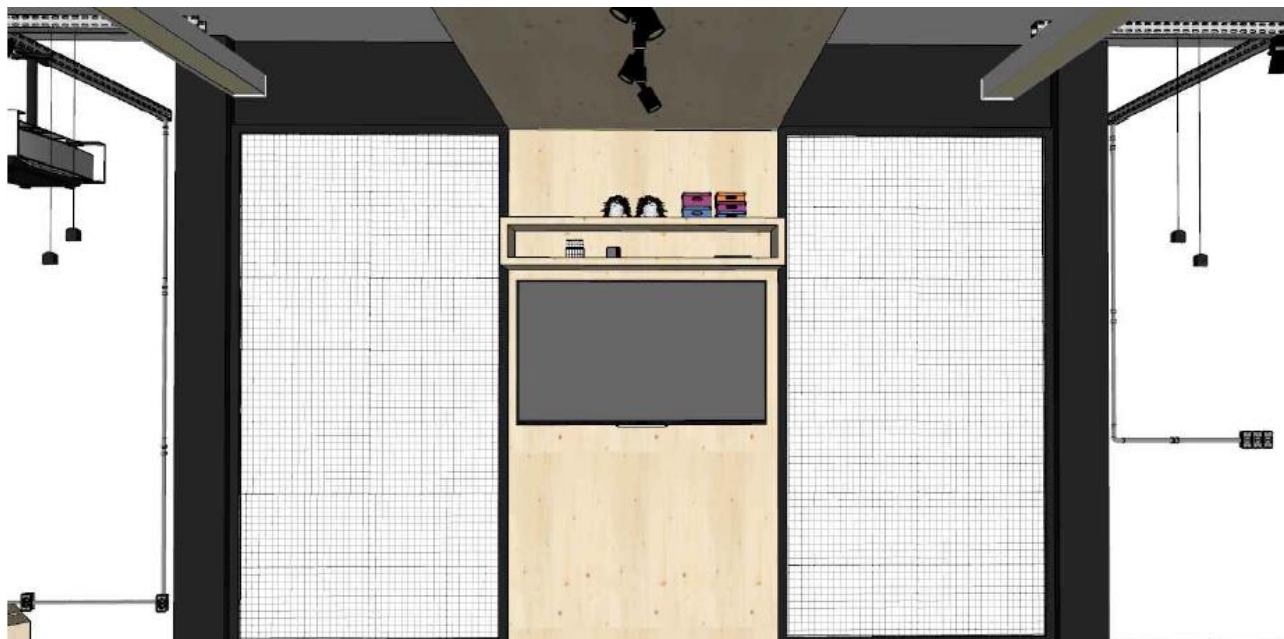
Figura 17 – Revestimento e nicho em compensado de virola, conforme dimensões indicadas em projeto
